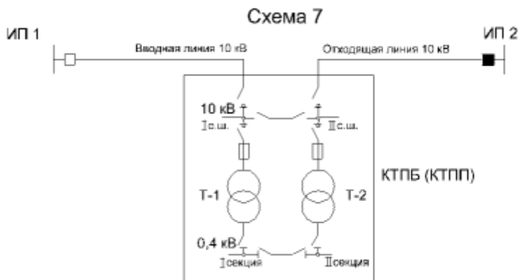
Рисунок 7 – Схема присоединения ТП 10/0,4 кВ, питающей потребителей категории 2
