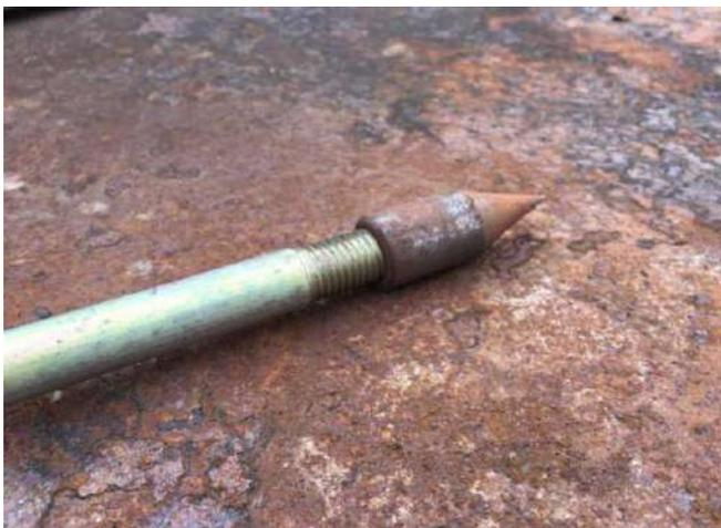
На верхний конец стержня заземления накручивается муфта, в которую до упора вкручивается головка забивочная.
