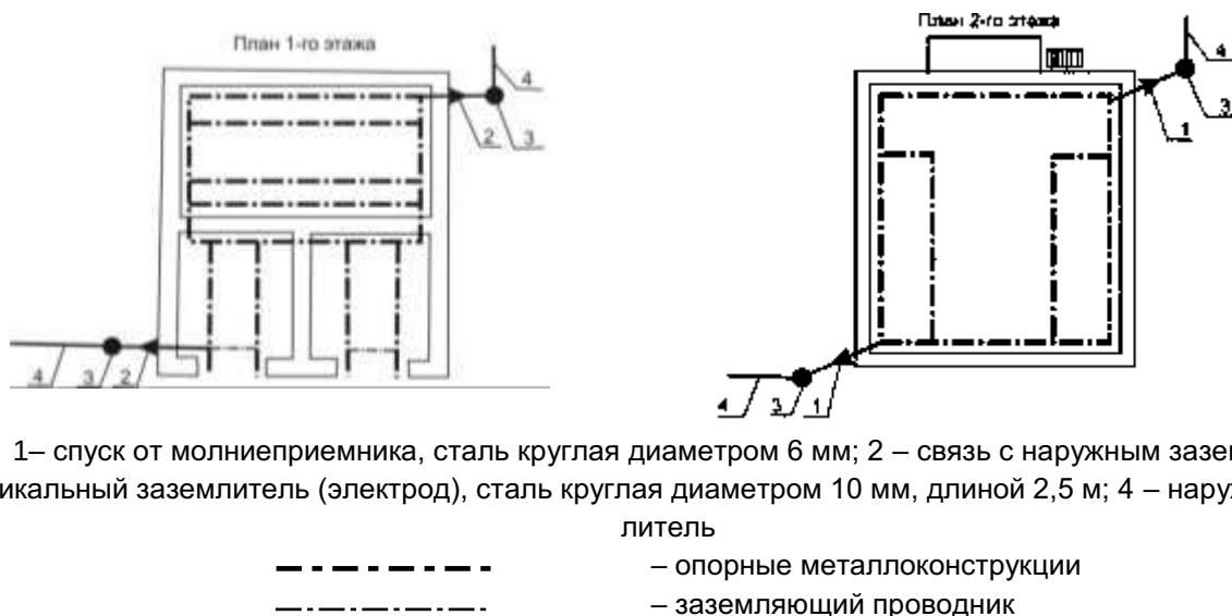
Рисунок 10.22 – Заземление внутри закрытой трансформаторной подстанции
