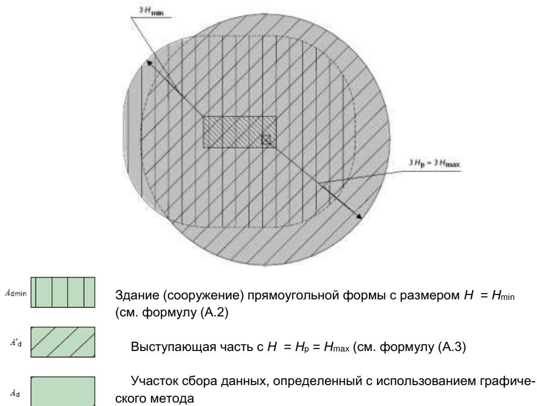
Рисунок А.3 – Различные методы определения участка сбора данных для здания (сооружения), изображенного на рисунке А.2
