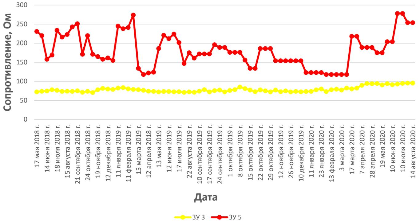
\* смесь вариант №2, размещенная в ЗУ 3, является промышленным образцом смеси для нормализации заземления «Поспех»
