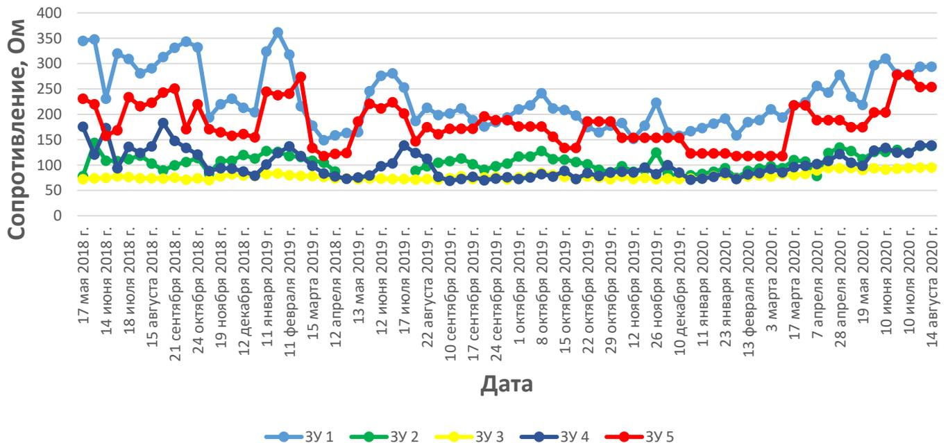
\* смесь вариант №2, размещенная в ЗУ 3, является промышленным образцом смеси для нормализации заземления «Поспех»
