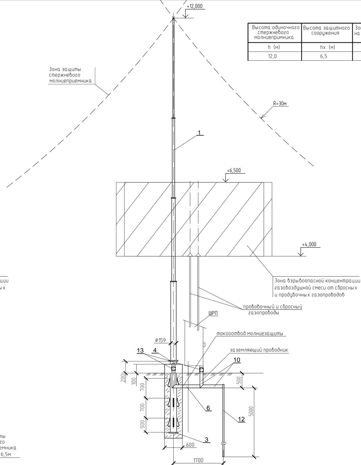
Зона защиты стержневого молниеприемника на высоте 6,5м
