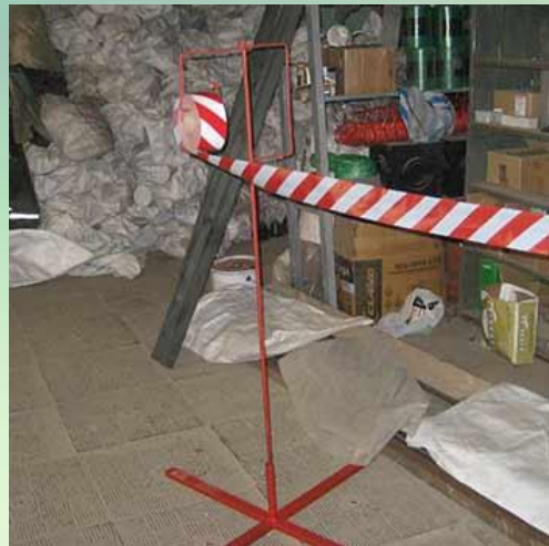
Стойка служит для разматывания ленты
